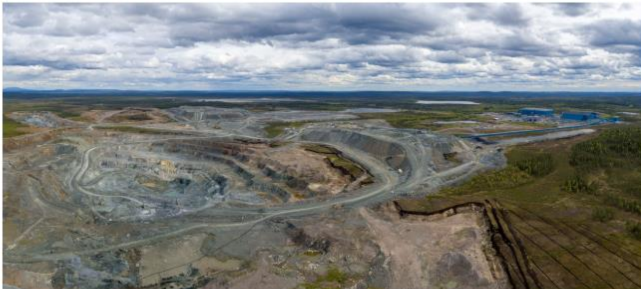
Figur 9.2. Foto över befintlig gruvverksamhet med dagbrott till vänster, upplag centralt i bilden och anrikningsverket till höger (Sweco 2019).
