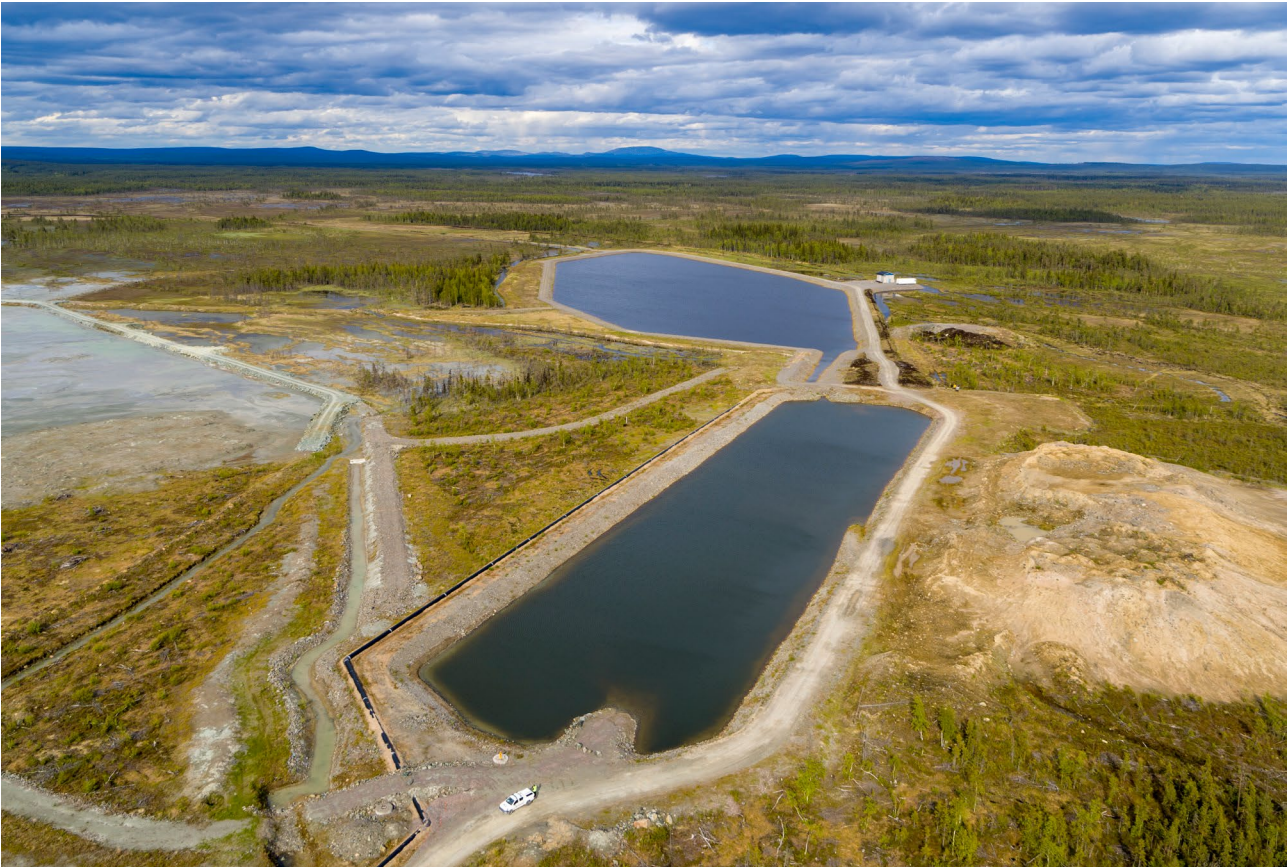
Figur 9. Foto över befintligt sandmagasin (till vänster) samt klarnings- och utjämningsmagasin. I bakgrunden ses myren Tapulivuoma (Sweco, 2019)
